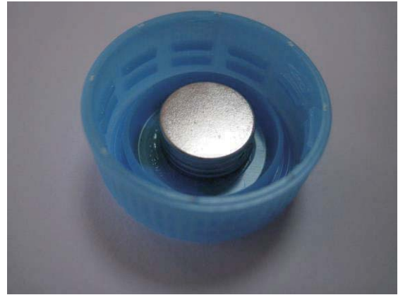
図2-10 磁石を両面テープでとめる
