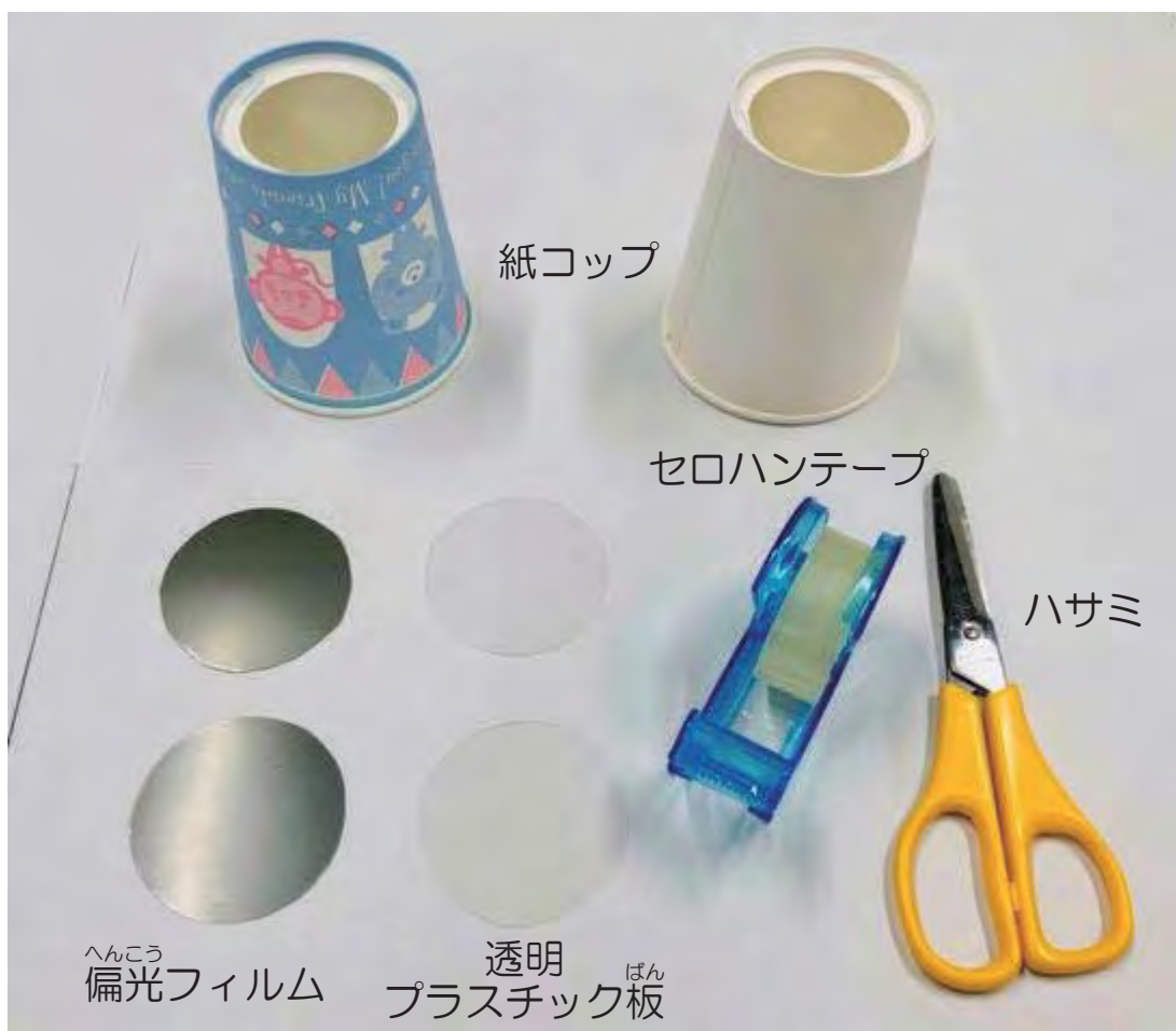
図2-1 偏光スコープ作製のための用意するもの
